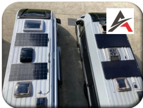
Affinity-Vans mit Solaranlagen: Flexpanels (links) / Rahmenpanels (rechts)
