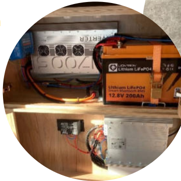
...oder Einbauten von Wechselrichtern, LiFePO4-Batterien und Ladeboostern.
