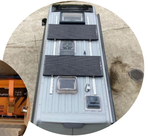
...Elektrifizierungen, wie z. B. dieser Einbau einer Solaranlage auf Airline-Schienen...
